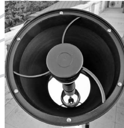
A TAL Klevcov-Cassegrain-távcső segédoptikájának görbült segédoptika-tartó lábak (a szerző felvétele)
