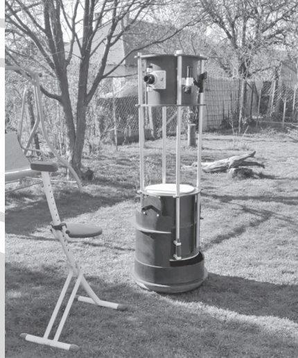
A szerző saját építésű, 300/1260-as Dobson-távcsöve (Hölgye Attila felvétele)
