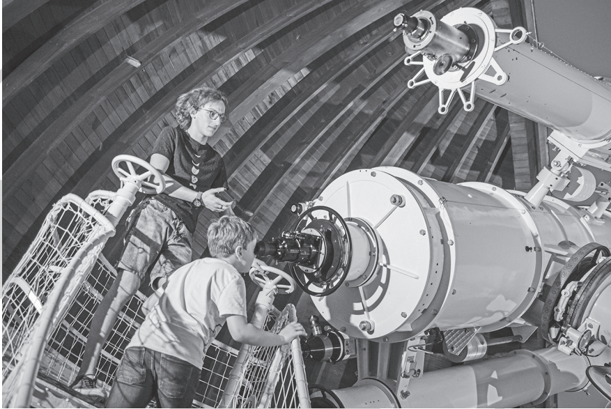
A 25 cm-es Merz–Konkoly-refraktor mai helyén, a 60 cm-es teleszkóppal párhuzamosan szerelve – mint bemutatótávcső (legfelső tubus), a Svábhegyi Csillagvizsgálóban (Budai Ákos felvétele)
