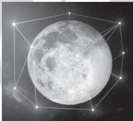
A Moonlight műholdhálózat sematikus ábrája (ESA)
