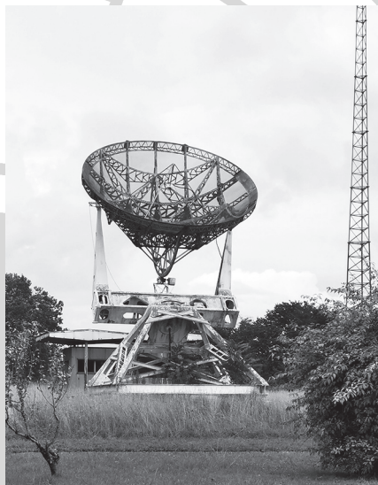
A II. világháborúból, az 1940-es évekből fennmaradt Würzburg típusú radarantennát rádiótávcsövé alakították át (Mónich László felvétele)
