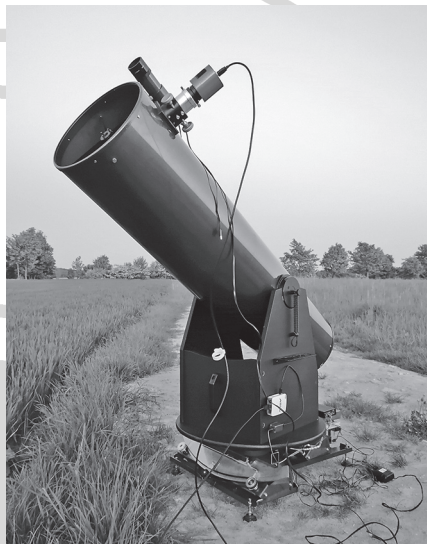
TS Optics 300/1500-as Dobson fotózásra felszerelve a TEPP (Triangulum Equatorial Photographic Platform) korai prototípusán
