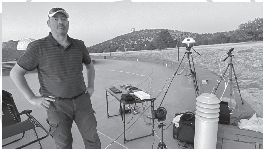
Igaz Antal a három meteorkamerával. Előtérben a 35x55 fokok látómezőben 8–8,5 magnitúdós határfényességű videókrögzésére képes Sony A7S kamera, jobb szélén a tűzgömbvadász mini kamera, hátul pedig az AllSky7 teljeségbolt-kamera. (Fotó: Rózsahegyi Márton)
