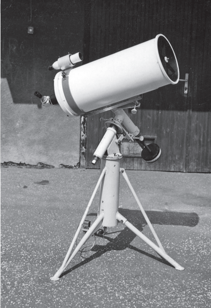
A 260/4100-as, Csatlós Géza által épített Nasmyth-távcső 1998-ban, eredeti mechanikáján (balra), és 2022-ben, az észlelőréten (jobbra)
