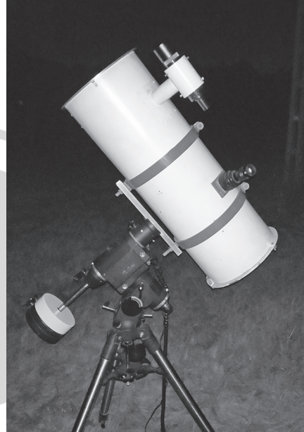
A 260/4100-as, Csatlós Géza által épített Nasmyth-távcső 1998-ban, eredeti mechanikáján (balra), és 2022-ben, az észlelőréten (jobbra)
