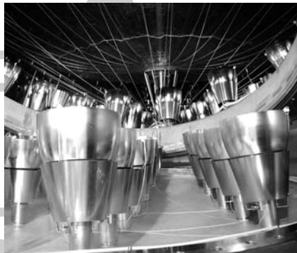
A Borexino-kísélet egyedi detektorai. Minden egyes, fotomultipliert tartalmazó detektor belépő nyílása 50 cm átmérőjű (Borexino Collaboration)
