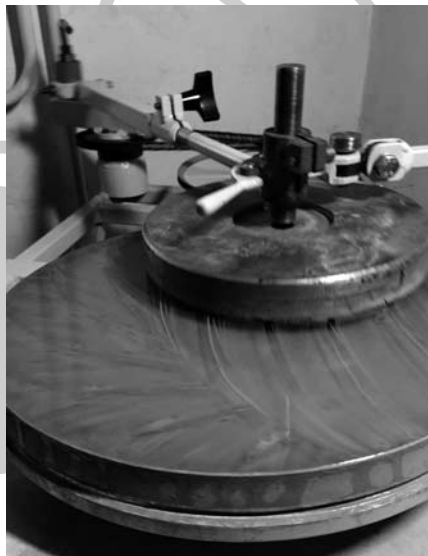
A szurok alumíniumtárcsára van öntve, furatába „kapaszkodik” a gép gömbfeje. Balra az előtoló hajtómű egésze látható, másik végén a fogattyúkkal. A tárcsa csaknem teljes löketének nyoma követhető polírozóanyagon
