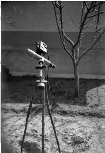
50/250-es refraktorom fusiban készült parallaktikus mechanikáján, Ljubityel-2 fényképezőgéppel a hátán. Nem volt ez apokromát, még csak akromát se, csak egyszerű kromát: erősen színező egytagú lencse bármilyen bevonat nélkül
