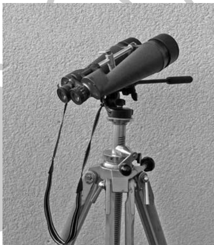
Mostanában szívesen észlelek ezzel a 20x80-as Vixen-binokulárral. Az állvány hihetetlenül masszív, még az NDK-s időkben készült. A panorámafej megfelelő magasságba emelhető, ha a változó nincs a zenit közelében, akkor nagyon kényelmes a betekintés
