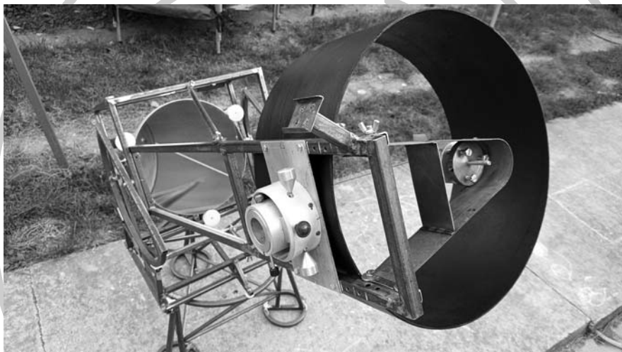
A párhuzamosan futó két gerinc tartja a Crayford-kihuzatot, a segédtükört, és az árnyékoló gyűrűt is. A segédtükör két csavar lazítása után behajtható a gerincbe.
