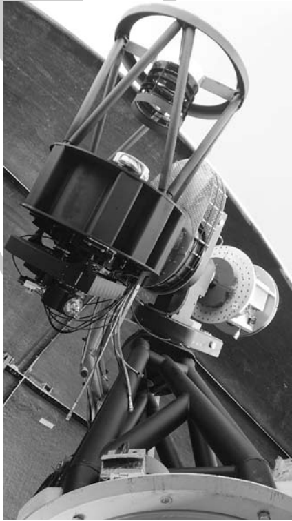
A BlackGem egyik 60 cm-es távcsöve magyar gyártmányú, Fornax 200-as mechanikán
