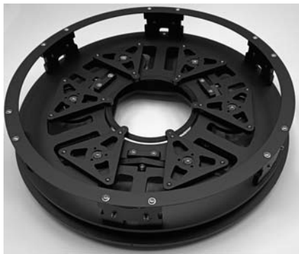
Az elkészült főtükörtartó, blende gyűrűvel
