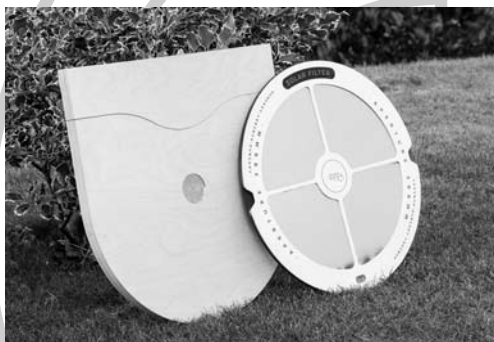
Az elkészült főtükörtartó, blende gyűrűvel
