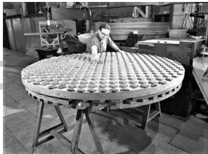
Texereau az Haute Provence-i Obszervatórium számára készülő 193 cm-es főtükörön dolgozva a fényező szuroktárcsa szegmenseit ellenőrzi
