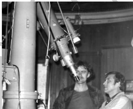
Papp Sándor barátommal a 19,2 cm-es Merz-Cooke-refraktornál, 1987 szeptemberében. A több mint 100 éves távcső okulárkihuzatában egy 25 mm-es Zeiss orthoszkopikus okulár, a keresőtávcső egy szovjet AT-1-es szputnyikkövető volt, akkora látómezővel, hogy a refraktor tubusvége is látszott benne
