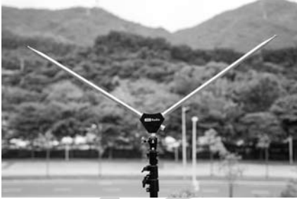
Készen vásárolható, hangolható V-dipól antenna
