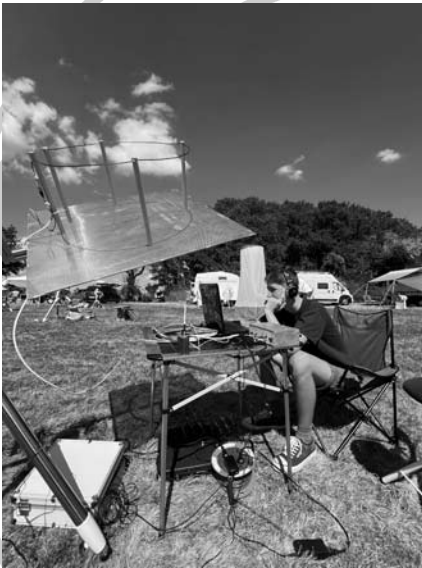
Ifjú amatőrcsillagász a Napot „hallgatja” egy EQ-5 mechanikára szerelt DDRR antennával az idei tarjáni találkozón
