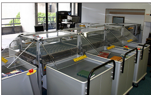
2. ábra Szállítószalag osztja a könyveket nyolc kocsira automatikusan 5
