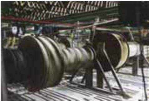
A barokk Bourla Színház fa színpadgépezetének vezérműtengelye a zsinópadláson
