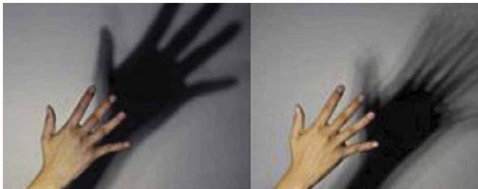
Egy pontizzós LED fényforrás; Ötpontizzós LED fényforrás
