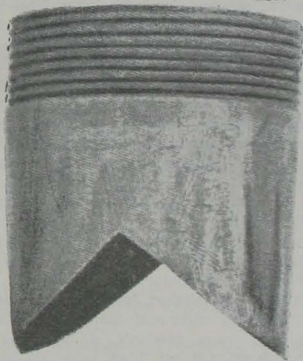
Az antipyrophor nevű kutató cső felcsavarható vége. Ezzel az antipyrophorral lehet megállapítani az öngyulladásos tüzfészeket és csatornákat a szénarakásban.
