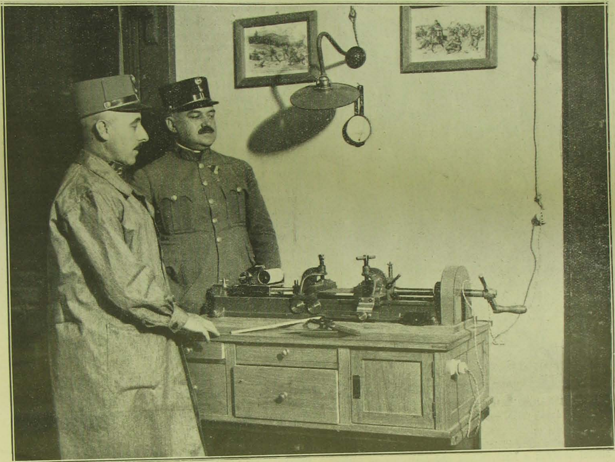
4. Szövetneműek mesterséges elszakítása, Rejtő tanár módszerével, egyenletes villanyerőhajtásra berendezett szakítógépen.
