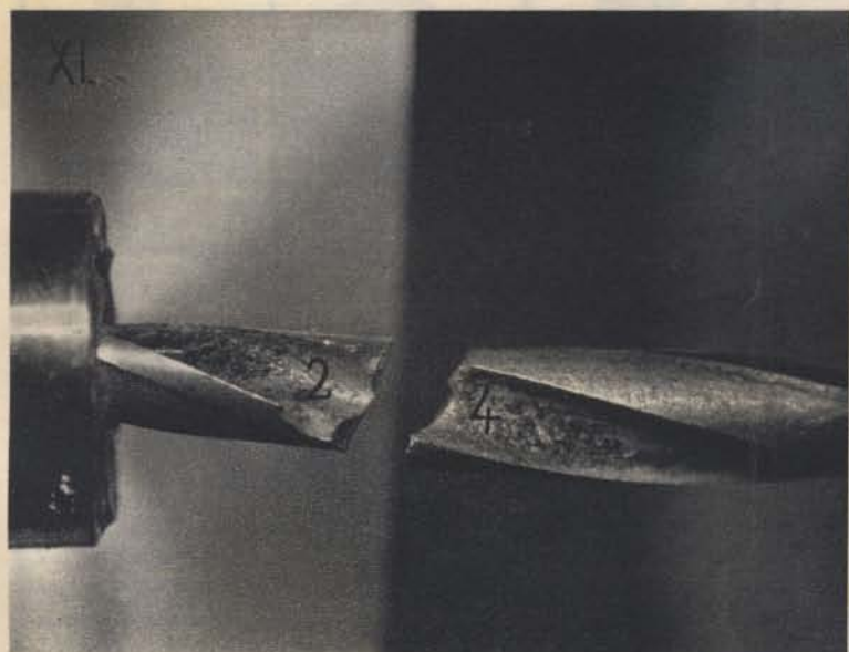
A helyszínen talált fúródarab (előbbi képen 2-el jelezve) és a gyanúsítottnál talált törött fúródarab (4-el jelezve) összehasonlítása négy különböző oldalról.
