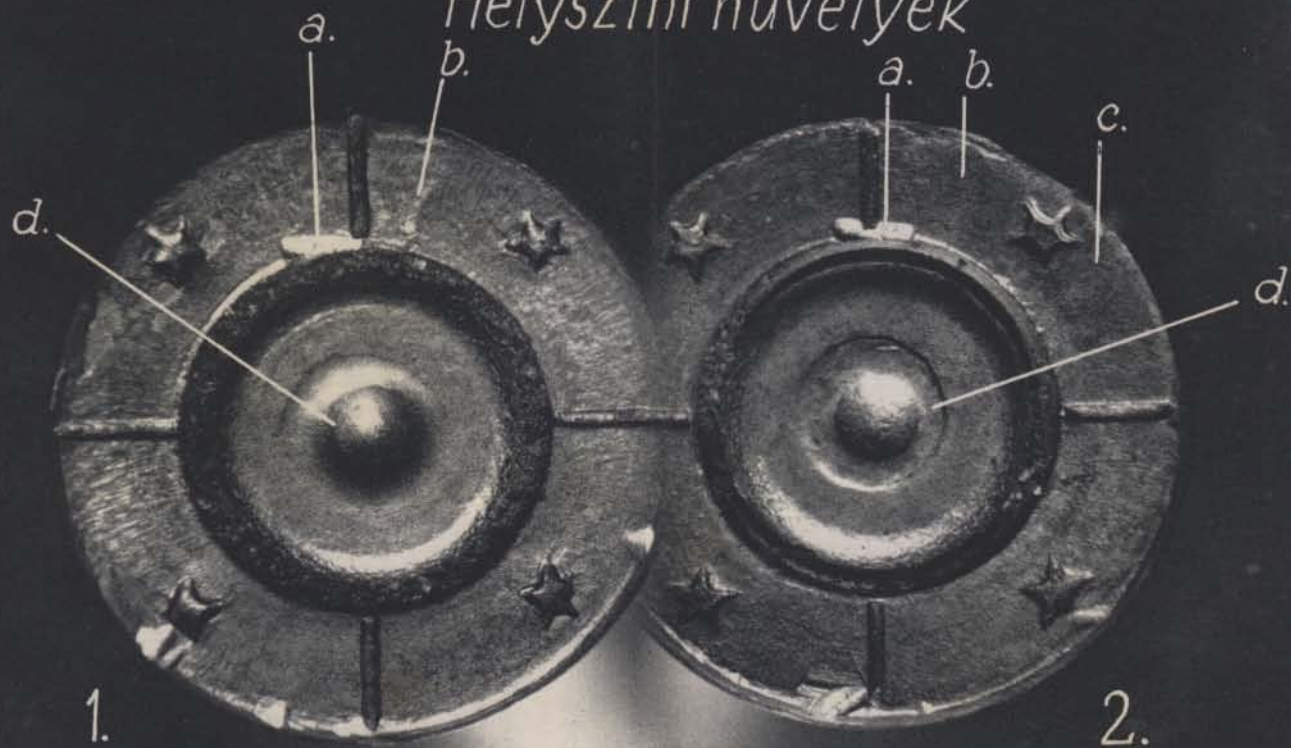
A helyszínen talált két töltényhüvely összehasonlítása.
