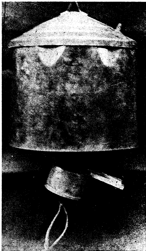
A romboló-léggömbre függesztett bádogtartály metszete és fényképe; lent: a fakorongos szerkezet.
