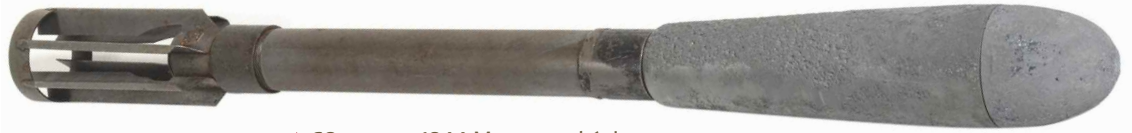
▲ 60 mm-es 1944 M magyar kézi rakétavető páncéltörő löszere
