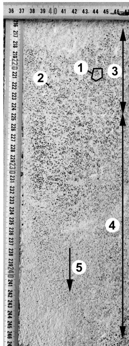
6. kép: Folytonos oldódásra utaló formák a fekvő közepes szemcseméretű fedő alatt Jelmagyarázat: 1. ujjbegy, 2. kürtő, 3. nagyméretű ujjbegyek zónája, 4. kisméretű ujjbegyek zónája, 5. dőlésirány Picture 6. Features referring to continuous and local dissolution under cover with medium grain size Legend: 1. finger tip, 2. pit, 3. zone with large finger tips, 4. zone with small finger tips, 5. dip direction
