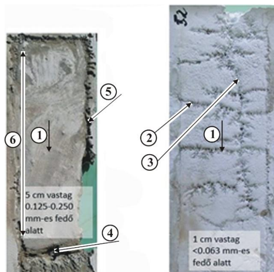
1. ábra: Oldási formák kis szemcseátmérőjű (<0,063-0,125 mm) fedő alatt. Jelmagyarázat: 1: lejtésirány, 2: keresztirányú vonalas oldásos forma, 3: hosszanti irányú vonalas oldásos forma, 4: a fedő elvégződésénél létrejött vonalas oldásos forma, 5: a fedő hosszanti szélé mentén létrejött vonalas oldásos forma, 6: oldásmentes felszín Fig.1: Dissolution features under small grain size cover (<0,063-0,125 mm). Legend: 1: dip direction, 2: transversal linear dissolution feature, 3: longitudinal linear dissolution feature, 4: linear dissolution feature at the ending of the cover, 5: linear dissolution feature at the longitudinal ending of the cover, 6: non solved surface
