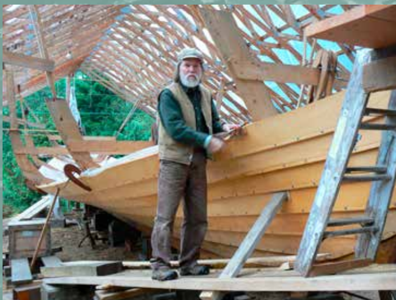
Hagyományos módszerekkel épített sárkányhajó
