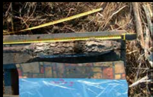
A fenékpusztai ókori erőd környezettörténeti feltárása során a Kis-Balaton öblébe mélyített zavartalan magfúrás részmintájában feltárt rétegsor, tavi mészsízzal és közbe-települt mocsári üledékekkel (a szerző felvétele)
