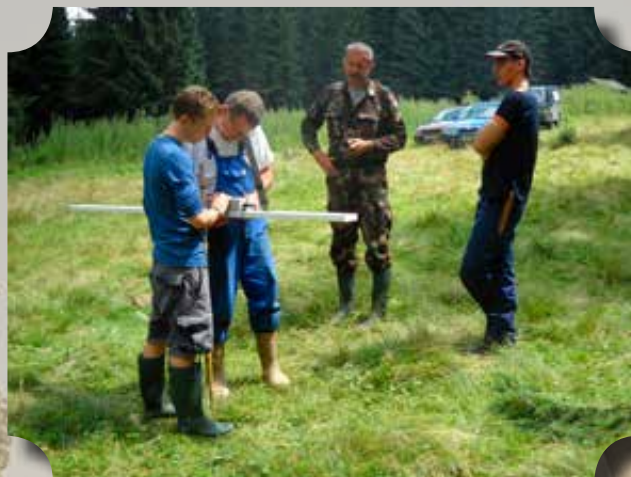
Geofizikai mérés GEM 3 típusú mérőműszerrel
