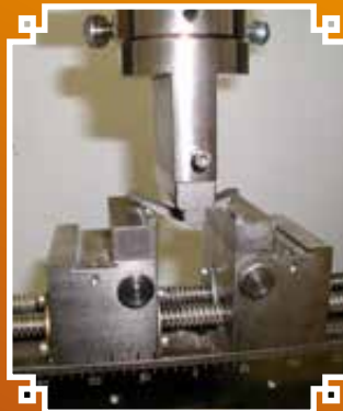
Thiele Ádám vezetésével folytatott mechanikai vizsgálatok típusai – első: Charpy-féle ütvehajlító, második: hárompontos hajlító vizsgálat, harmadik: szakító vizsgálat (Budapesti Műszaki és Gazdaságtudományi Egyetem)
