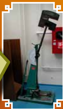
Thiele Ádám vezetésével folytatott mechanikai vizsgálatok típusai – első: Charpy-féle ütvehajlító, második: hárompontos hajlító vizsgálat, harmadik: szakító vizsgálat (Budapesti Műszaki és Gazdaságtudományi Egyetem)
