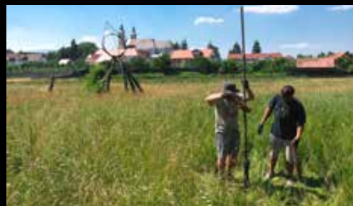
Csiksomlyó, Barátok kaszálója lápréten kialakított zavartalan magfúrás a székellyöldi környezettörténeti kutatások keretében (a szerző felvétele)
