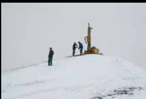
A Karcag-Berekfürdő határában található Ecse-halom zavartalan fúrásos feltárása nagyteljesítményű motoros fúrógéppel (a szerző felvétele)
