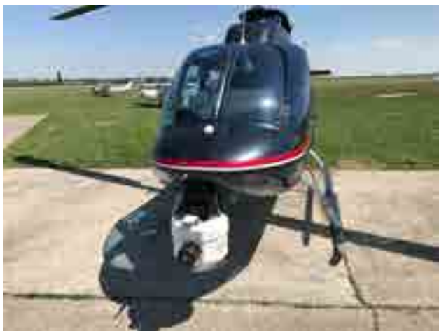
Riegl VP-1 VUX LiDAR egység helikopterre szerelve
