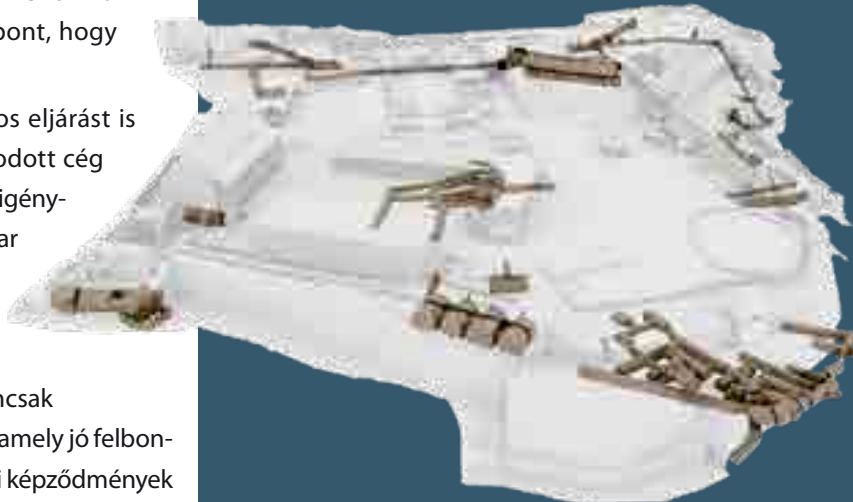
Az egri vár kazamata- és pincerendszerének lézerszenneres állománya vizualizálva (térskennelés: MindaGIS Kft.)
