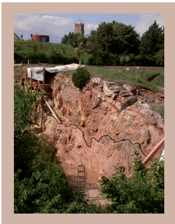
6. ábra. Törésses kőzetzóna a nagy kőfejtőfal keleti végén. A fekete vonal alatt alsó jura, tengerililiomok (Crinoideák, a későbbiekben krinoideák) vázelemeiből keletkezett mészkő, a „vörösmárvány” rétegsor legfelső tagja van, míg felette változatos, helyenként kaotikusan tört fiatalabb jura kőzetek.
