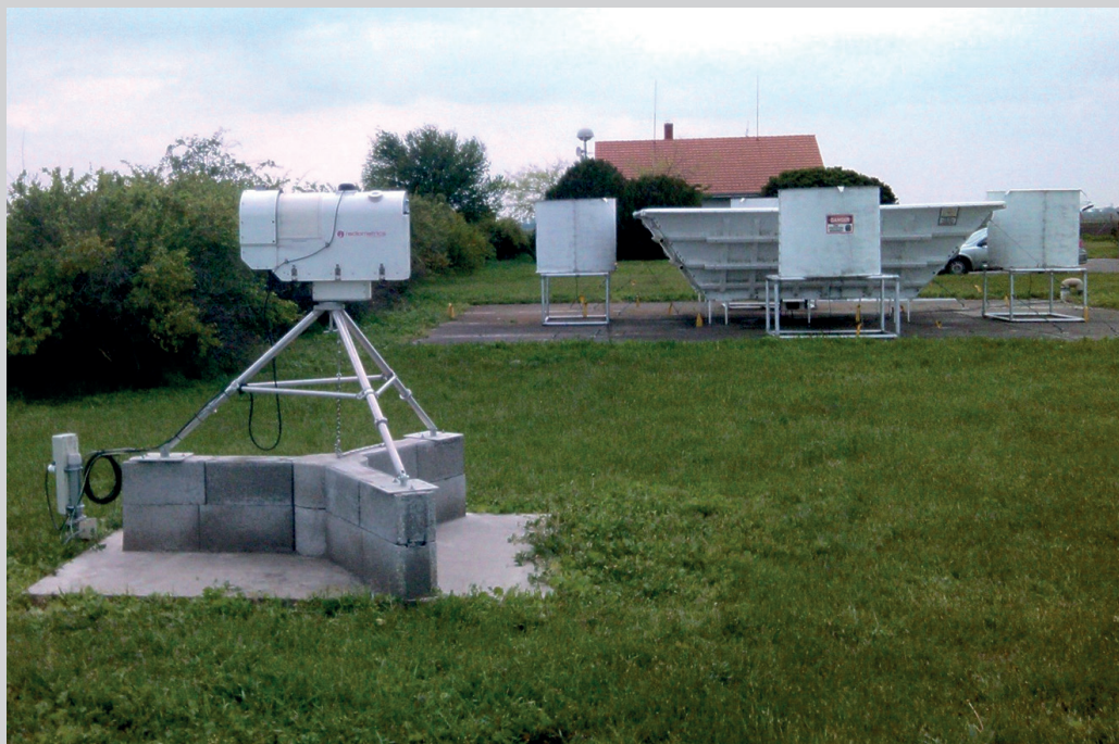
5. ábra. A Szegeden telepített radiométer (MP-3070A típus), ami hőmérséklet, légnedvesség és folyékony víztartalom meghatározására alkalmas. Háttérben a szélprofilmérő (forrás: OMSZ)
