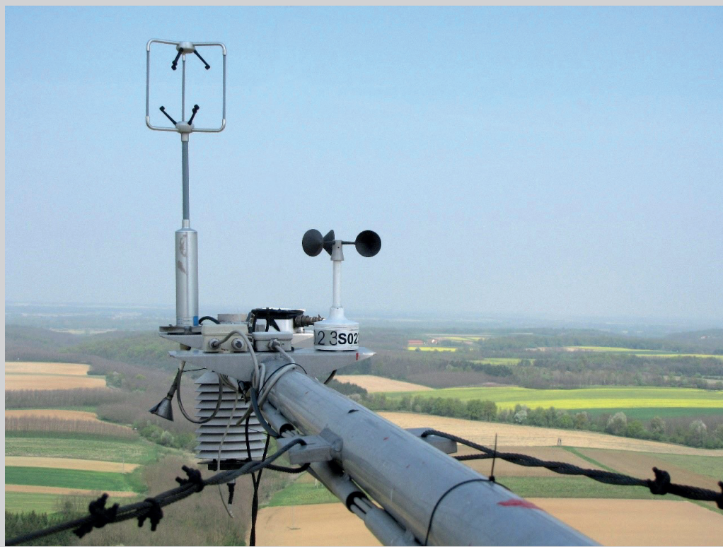
3. ábra. Szónikus és forgókanalas szélmérő Hegyhátsálon a TV-tornyon (fotó: Haszpra L.)
