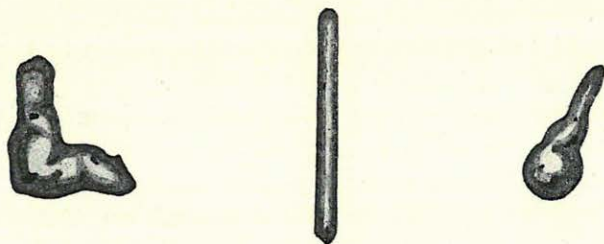
15. ábra. Rutilszemek az örsödi kék agyagból, 8 m mélységből. (Vonalas nagyítás = 1 : 280.)
