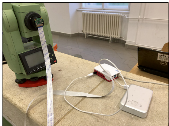
1. ábra. Mérőállomásra rögzített Pi V2 kamera
