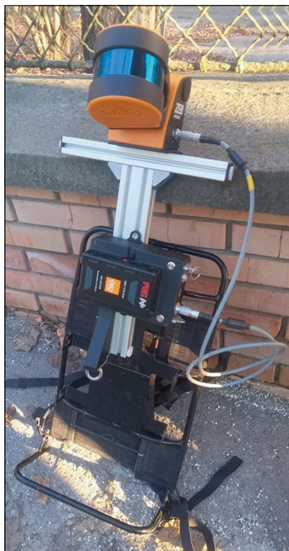
1. ábra. A hátkeretre szerelt változat
