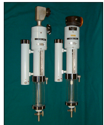
25. ábra. A Miskolci hidrosztatikai szintező
