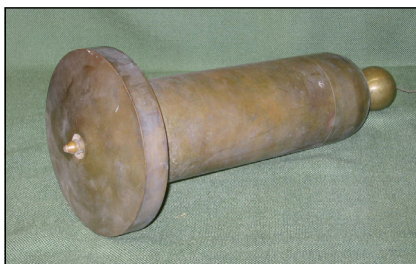
9. ábra. A Veith-féle függőlemez súly Szentistványi Gyula által továbbfejlesztett változata (Miskolci Egyetem Geodéziai és Bányaméréstani Tanszék)
