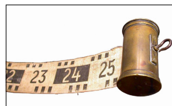
7. ábra. Selmeci szintezőszalag (Forrás: Központi Bányászati Múzeum, Sopron)
