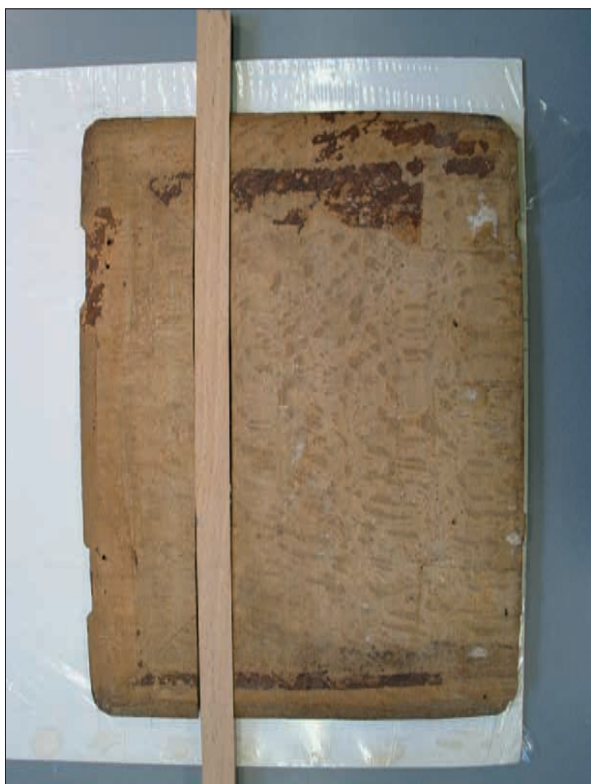
90. ábra A szétvágott fatábla a vágásba helyezett pótlással
