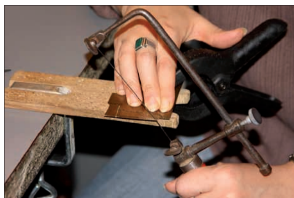
96. ábra A csat körvonalainak kifűrészelése a lemezből
