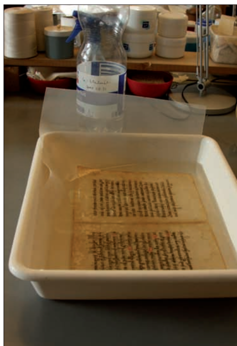
63. ábra A kódexlap a fitátos fürdőben
