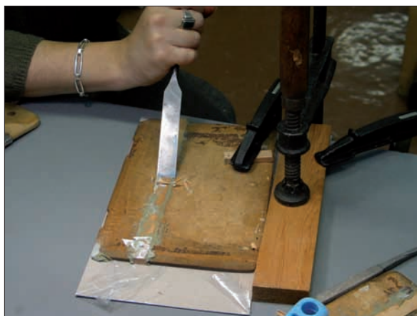
93. ábra A toldás méretre vésése
