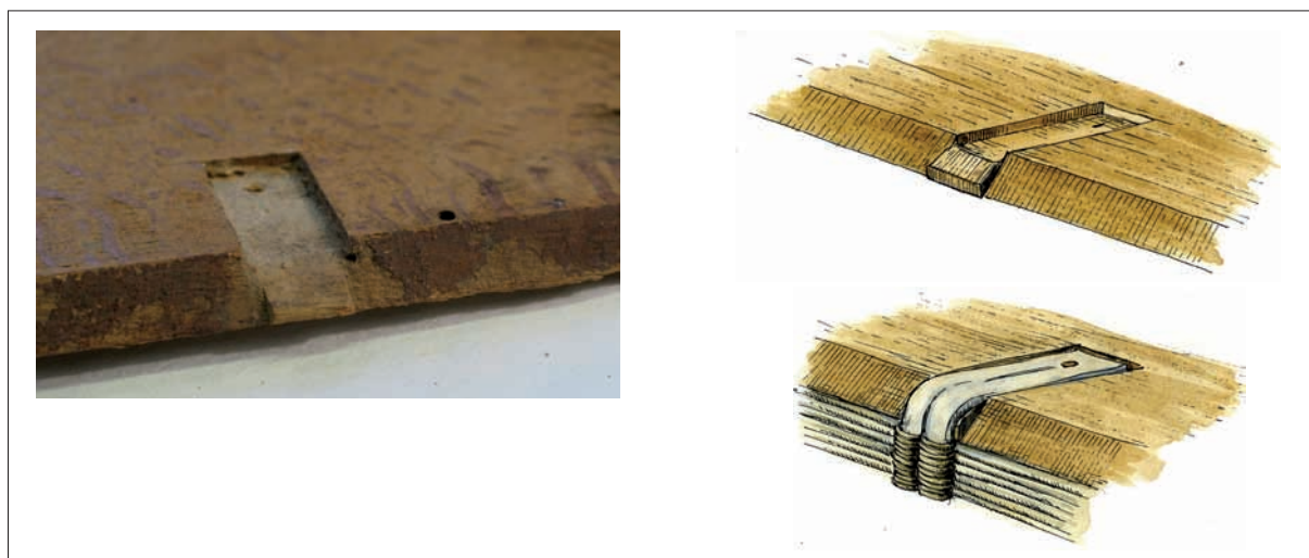
21–23. ábra A bordák alatt kialakított kiemelés a fatábla részsútolásán
