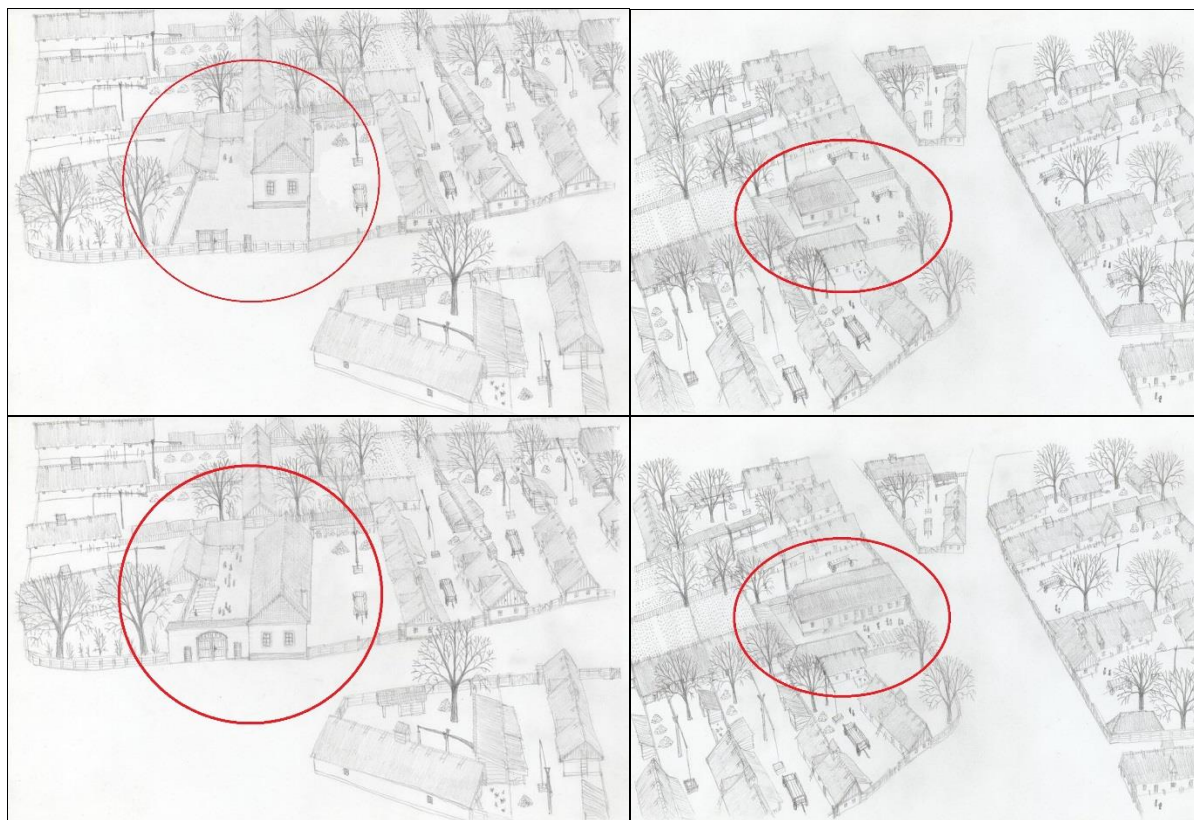
12-15. kép: A Kígyó utca 55. számú ház rekonstrukciós rajza még előkerttel, majd később utcafronti toldalékkal ellátva 29
