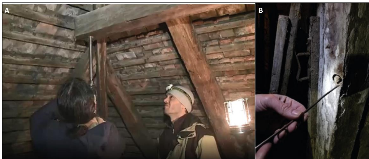
6. kép Mintavétel az egykori Novella csapszék épületfáiból. A: mintavétel a tetőszerkezet faanyagából (mintakód: DEB007); B: furatminta kiemelése a pincében talált ajtótokból (mintakód: DEB021) 12
