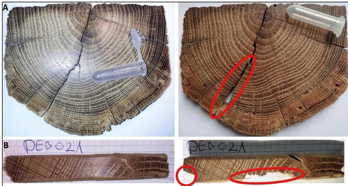
8. kép Az egykori Novella csapszék (Kígyó utca 55. szám) épületfáiból radiokarbon-elemzésre kiválasztott minták. A: DEB013 minta a részminták kivágása előtt (bal) és után (jobb); B: DEB021 minta a részminták kivágása előtt (bal) és után (jobb). A pirossal keretezett „anyaghiányok” a radiokarbon vizsgálatra kimetszett évgűrű-szakaszok helyét jelölik 23
