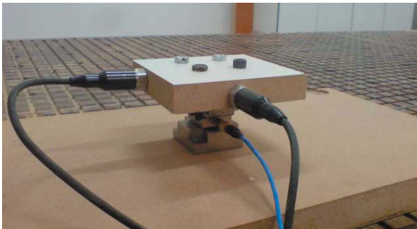
3. ábra: Rezgémérő műszer munkadarabra rögzítése
