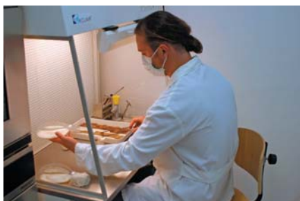
Gombaállósági vizsgálat előkészítése
