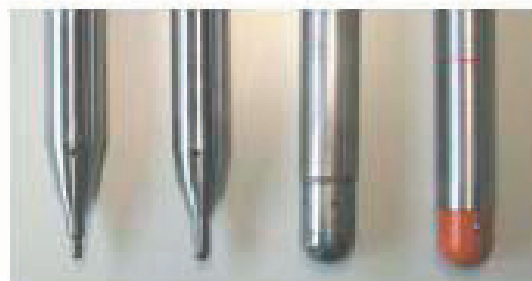
4. ábra. Különböző bélyeg kialakítások inkrementális alakításhoz
