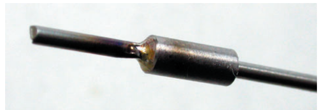
3. ábra. CO 2 lézerrel hegesztett munkadarab
