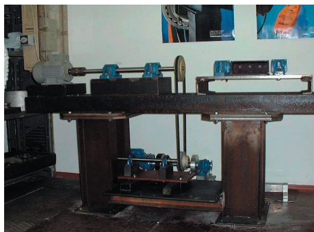
3. ábra. Az U-1000 próbapad szerkezeti felépítése „Laval tengely” (bal oldali kép), illetve csapágy kifáradás és ékszíj rezonancia vizsgálatokhoz (jobb oldali kép) felszerelve (2002)
