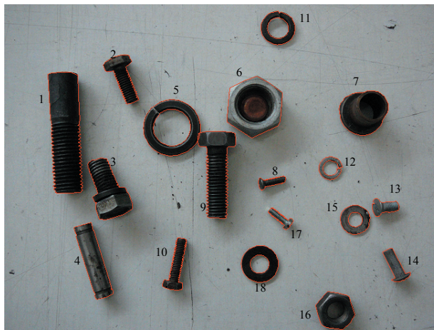
1. ábra. Különböző méretű szétszerelt kötőelemek és a képfeldolgozással meghatározott kontúrok
