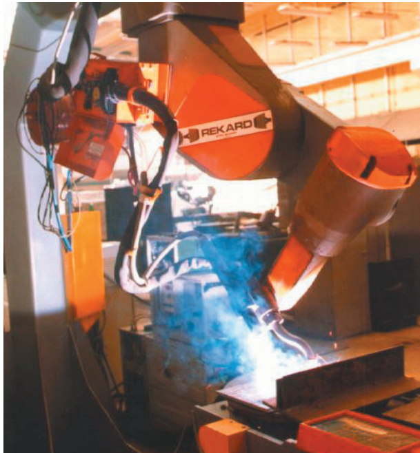
9. ábra. 3D-s pályavezérlésű ívhegesztő robot
