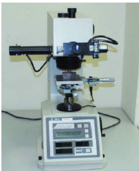
3. ábra. Mitutoyo mikro-keménységmérő berendezés
