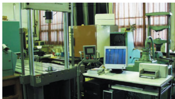
6. ábra. MTS 322 típusú, biaxiális szerkezetvizsgáló berendezés
