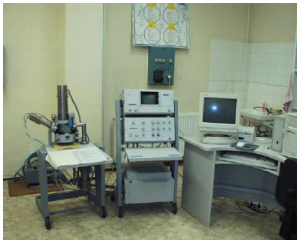
1. ábra. TESLA BS 343 scanning elektronmikroszkóp
