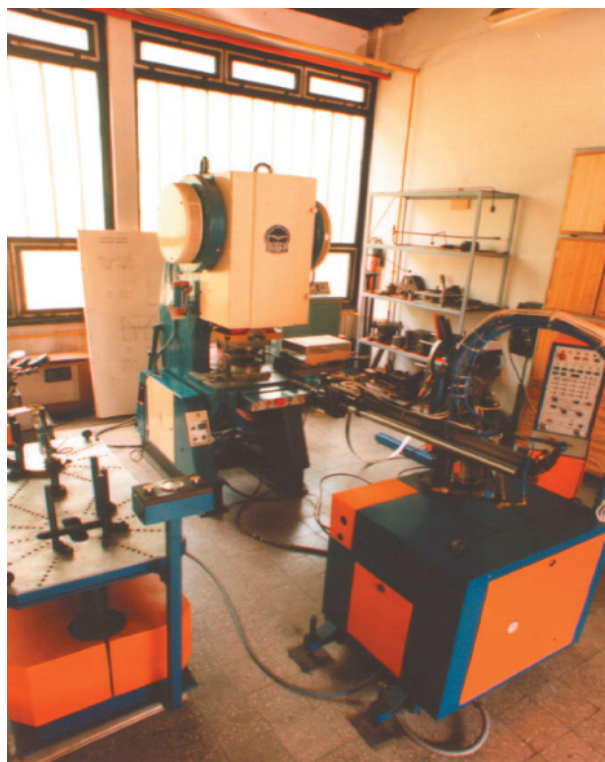
8. ábra. Rugalmas alakító gyártócella a képlékenyalakító laboratóriumban
