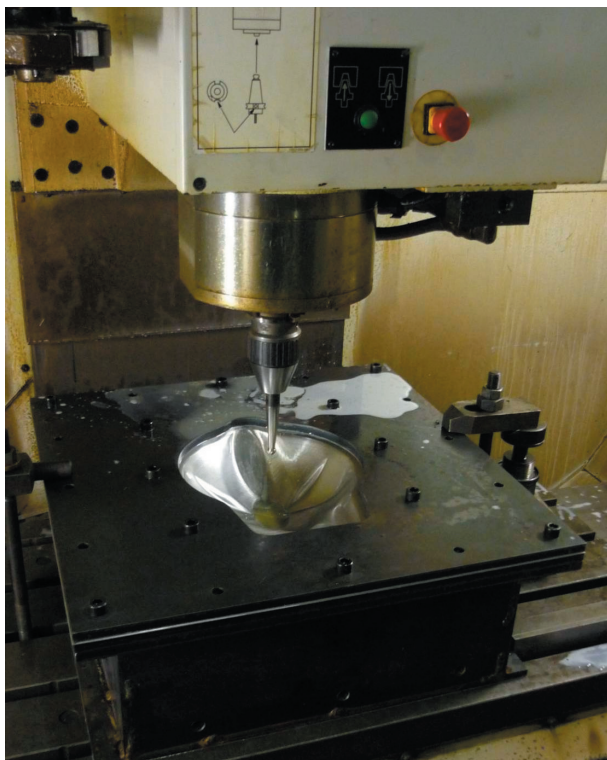
4. ábra. A kísérleti szerszám a szerszám a megmunkáló központ befogó elemeivel
