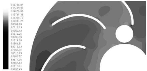
12. ábra. Nyomáseloszlás a visszavezető kerékben a B jelű sík mentén
