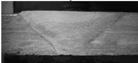
7. ábra. Jó minőségű varrat ( n = 1000 \text{ ford/min} , v_h = 250 \text{ mm/min} , \varphi = 0^\circ )
