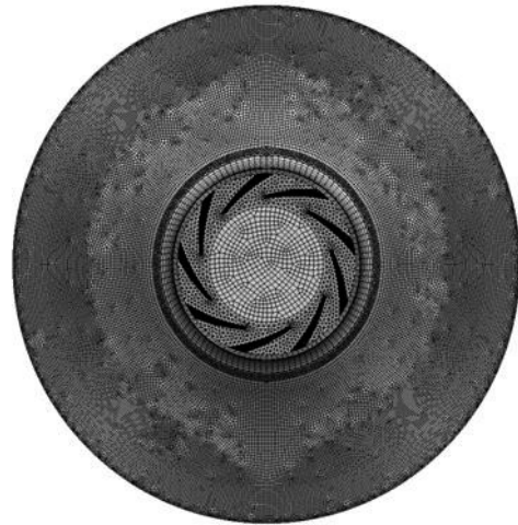
6. ábra. Járókerék felületén kialakított hálózás képe
