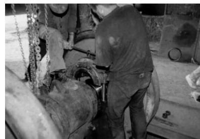
3. fénykép. Csapágyház felső fél helyrerakása
