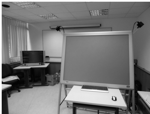
2. kép: Sztereoszkópikus megjelenítő rendszer vászna, a tetején elhelyezett mozgáskövető kamerákkal
